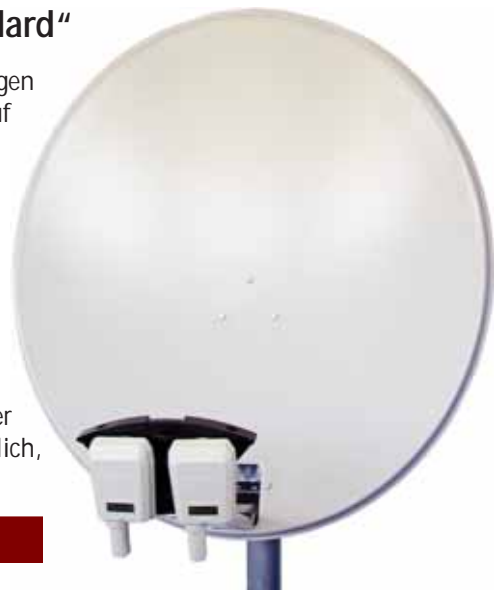
TRIAX Standard-Antenne mit 6°-Multifeedhalterung und 2 LNB's zum Empfang der Satelliten Astra19,2° und Hotbird13°
