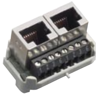
LAN-Einsatz für Multimediadose mit 2 x RJ45, einfache Montage, Schraubklemmen mit Drahtschutz, geschirmt, Kat. 5e
