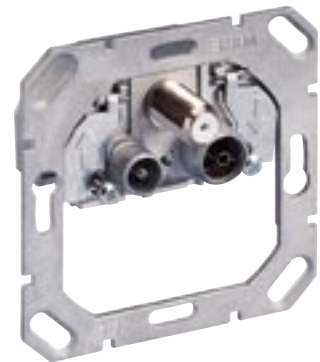
Einzel- oder Stickleitungs-dose für Radio, TV und SAT, IEC-Anschlüsse für Radio und TV (5-862MHz) sowie F-Buchse für Satelliten-Receiver (950-2150MHz), mit LAN-Einsatz für Netzwerk erweiterbar
